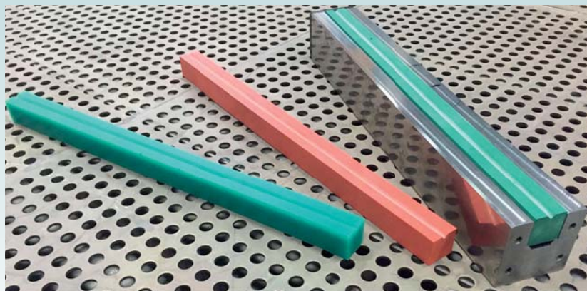
Figura 6 - Matrice da piegatura ad inserti a basso costo sviluppati dai ricercatori MUSP
